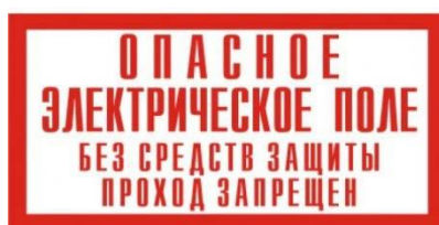
Рисунок 5 - Опасно! Электрическое поле! Без средств защиты проход запрещен
