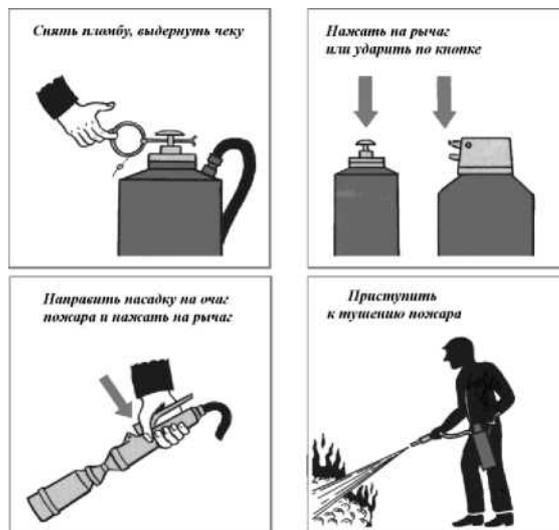
Рис. 9. Приведение в действие воздушно-пенного огнетушителя (плакат)
