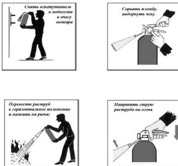
Рис. 8. Приведение в действие ручного углекислотного огнетушителя (плакат)
