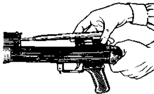
Рис. 6. Отделение возвратного механизма Рис.7. Отделение затворной рамы с затвором
